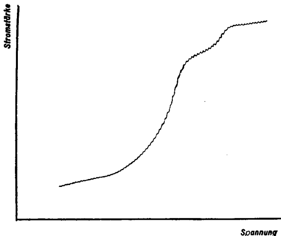
Abbild. 2. Stromspannungskurve einer 2 Stdn. bestrahlten Lösung von Azobenzoldisulfonsäure.
